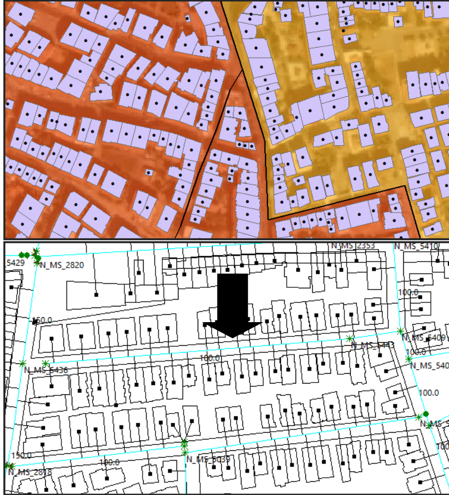
Şekil 6: Su ihtiyacının (tüketim debisi) dağıtılması (MASKİ Su Temini ve Rehabilitasyon Projesi, 2016)
