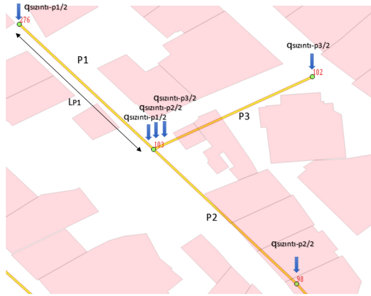
Şekil 7. Sızıntı Debisinin Düğüm Noktalarına Dağıtılması
