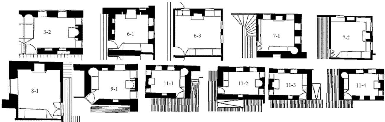
Şekil 11. Ocak Duvarı ve Yüklük Duvarının Birlikte Olduğu Odalar
