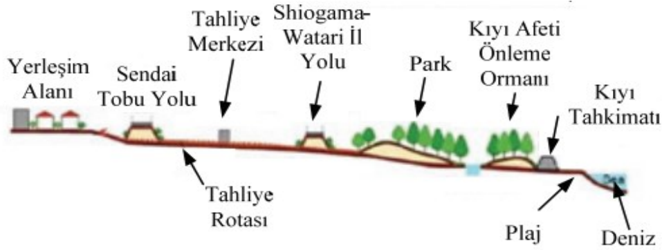
Şekil 10. Japonya Tsunmami için kıyı bölgesi önlemi (Güler vd, 2018)
